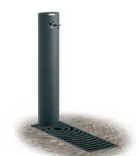
Fontana costituita da una struttura in tubo d'acciaio zincato a caldo e verniciato a sezione ellittica 10x20 cm di altezza 99 cm con piastra a base rettangolare 29x14 cm e tappo superiore in lamiera. Il rubinetto in ottone nichelato è del tipo a pulsante con molla di ritorno normalmente chiuso. La struttura è fissata con quattro viti alla base della vasca in lamiera d'acciaio zincato a caldo e verniciato di dimensioni 29,6x89 cm e profondità 10,2 cm dotata di tubo di scarico.
