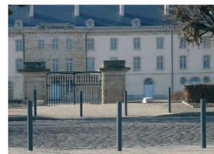
Dissuasore di altezza 85 cm fuori terra, realizzato in tubolare d'acciaio diametro 10x 0,3 cm con chiusura superiore in lamiera sp. 0,3 cm. Il fissaggio al suolo è previsto rispettivamente con piastre base di diametro 17x 0,6 cm con fori per il fissaggio con tasselli oppure con prolungamento per essere cementato direttamente al suolo per una profondità di 15 cm.
