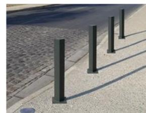
Dissuasore di altezza 85 cm fuori terra, realizzato in tubolare d'acciaio sez.10x10x0,2 cm con chiusura superiore in lamiera sp. 0,3 cm. Il fissaggio al suolo è previsto rispettivamente con piastre base 20x20x0,6 cm con fori per il fissaggio con tasselli oppure con prolungamento per essere cementato direttamente al suolo per una profondità di 15 cm.
