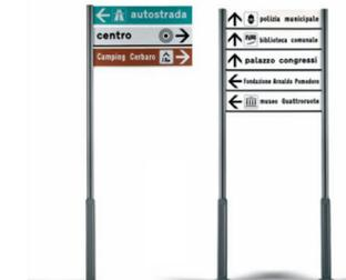
Palina informativa composto da uno o due elementi verticali, interamente in alluminio ma con anima interna in acciaio zincato, e da tabelle segnaletiche in estruso d'alluminio. Tutto il materiale è verniciato a polvere poliestere. Il fissaggio al suolo avviene annegando al suolo l'anima in acciaio. Il modello "a bandiera", per ragioni statiche, può ospitare fino a un massimo di 3 tabelle, mentre il modello a due supporti, fino a 5.
