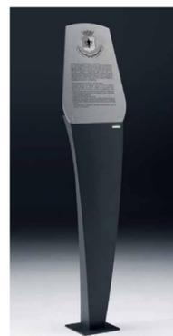
Palina illustrativa composta da un supporto in lamiera d'acciaio zincata verniciata, costituita da un profilo curvo con piastra base 25x25 cm e da un pannello sagomato in acciaio inox satinato che viene fissato al supporto con viti a testa svasata piana. Dimensioni 43,6x66 cm, altezza totale 2,00 m.
