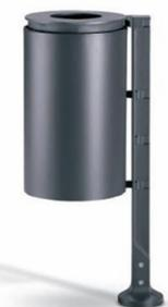
Il cestino portarifiuti è costituito da un paletto in fusione di alluminio, un contenitore in acciaio zincato e un coperchio in fusione di alluminio con cerniera a tre ali in fusione di acciaio inox per l'apertura. Tutti i componenti sono verniciati con polvere poliestere ed il fissaggio al suolo può avvenire annegando l'anima interna in acciaio. Diametro 33 cm, altezza 95 cm.
