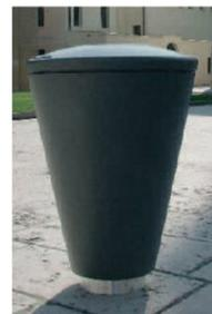
Il cestino è costituito da una struttura tronco conica in lamiera di acciaio, diametro maggiore 59 cm, diametro minore 30 cm, altezza 68,5 cm. il coperchio in fusione di ghisa di diametro 60 cm, si apre con rotazione orizzontale. Altezza totale 82,6 cm.
